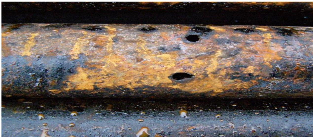
Сурет 1. Минеральды тұздар әсерінен коррозияға ұшыраған жабдық
